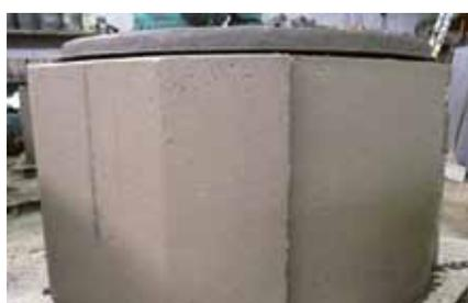
Schachtunterteil aus Beton mit 10 % Zementeinsparung bei gleichzeitiger Zugabe von 15 % Altbetonmehl.
